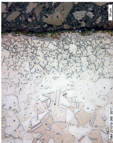
Fig. 11: Immagine micrografica elettronica a scansione di un attacco selettivo Zona saldata di un materiale 1.4401, (A4, 316).
