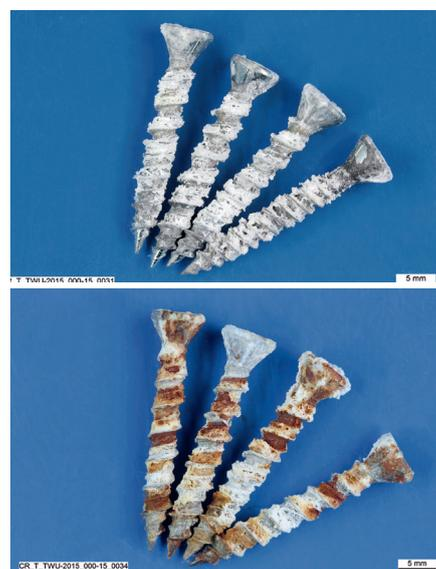
Fig. 14: Viti elettrolitiche galvanizzate con un rivestimento allo zinco di circa 5 µm dopo 48 ore (su) e 96 ore (giù) di test della nebbia salina.
