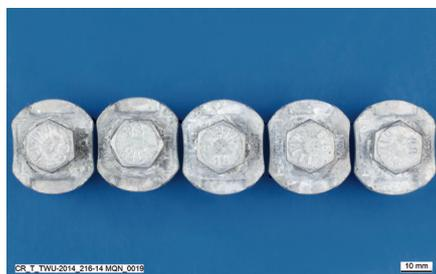
Fig. 18: Parte di connettore con rivestimento multistrato (rivestimento in fiocchi organici) dopo dieci settimane di test ISO 20340 con radiazioni UV.
