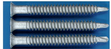
Fig. 20: Viti con rivestimento multistrato altamente resistente alla corrosione dopo 15 cicli di test della corrosione con diossido di zolfo (non presenta alcuna corrosione).
