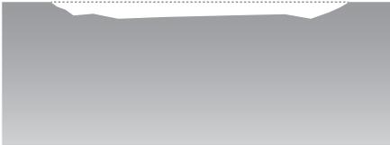
La corrosione uniforme è una forma di corrosione in cui la superficie viene rimossa in modo quasi omogeneo.
