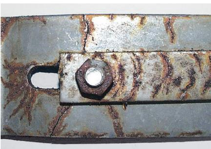
Fig. 8: SCC di una staffa realizzata con materiale 1.4301 (A2, 304) dopo circa 4 anni di utilizzo in una piscina coperta.
