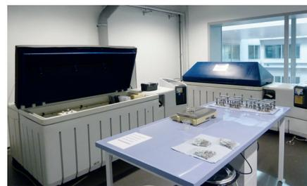
Fig. 13: Immagine dal nostro laboratorio di corrosione con diverse camere di test della corrosione.
