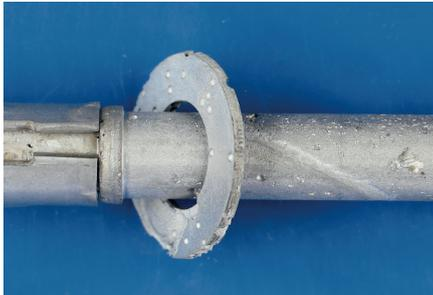
Fig. 5: Esempio di corrosione alveolare su un prodotto in acciaio inox.
