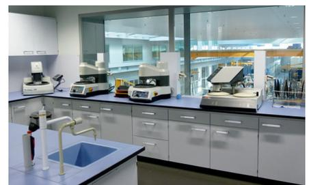
Fig. 23: Apparecchiatura del laboratorio metallografico (rettifica e levigatura).
