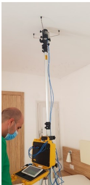
Stativo, energizzatore, microfono e centralina di acquisizione
