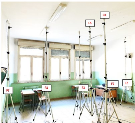
Piano primo - posizionamento aste telescopiche con trasduttori
